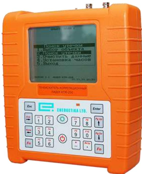
Корреляционный течеискатель КТМ-250 предназначен для поиска и определения мест утечек жидкостей из трубопроводов, находящихся под давлением в коммунальном хозяйстве, теплоснабжении, на нефтепромыслах, в нефтехимической и газовой, пищевой и других отраслях промышленности.
