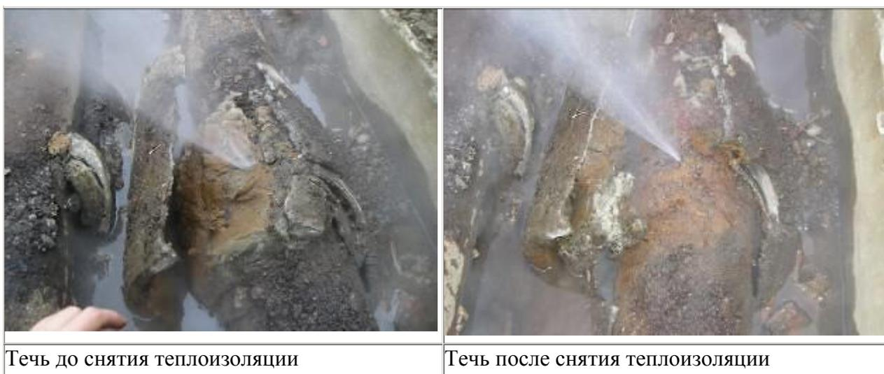
Рис 6. Снижение энергии сигнала от течи за счет «стесненного» выхода через теплоизоляцию.
