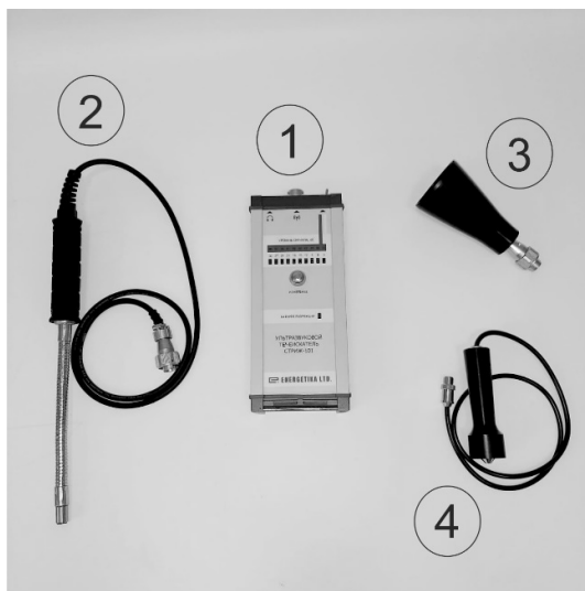
Рисунок 1. Состав ультразвукового течеискателя СТРИЖ-101
