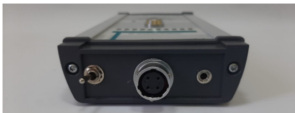
Рисунок 2. Разъемы передней панели прибора СТРИЖ-101.
