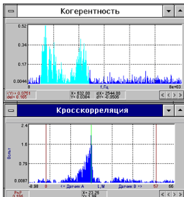
Рис.42. Определение места утечки (полоса анализа 632- 3176 Гц).
