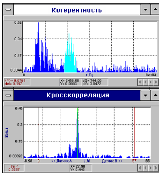
Рис.41. Определение места утечки (полоса анализа 2456- 3200 Гц).
