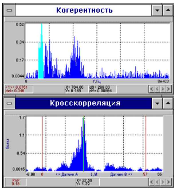
Рис.39. Определение места утечки (полоса анализа 704- 992 Гц).
