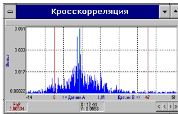
Рис.59. Функция кросс корреляции, полученная при простукивании по схеме на рис.58.
